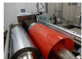
Fig1. 樹脂凹版の外観(左)、樹脂凹版の使用状況(右)
