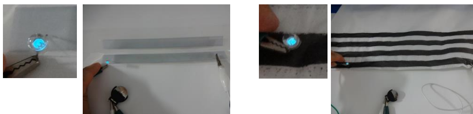
Fig8. 各インキ塗布後の導電性確認（左：PEDOT、右：カーボン）
