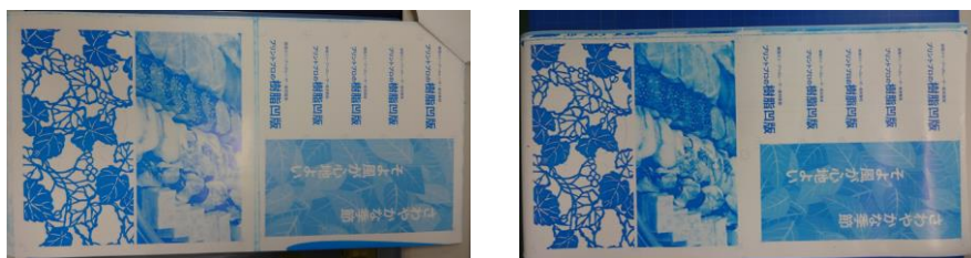
Fig5. 印刷結果外観（左：溶剤系インキ、右：水系インキ、長さ 630mm、幅 320mm）
